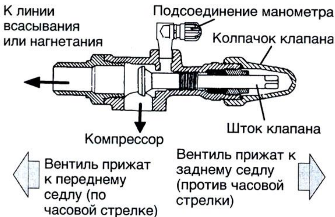
Рис.6-3. Вентиль обслуживания на линии всасывания или нагнетания.
