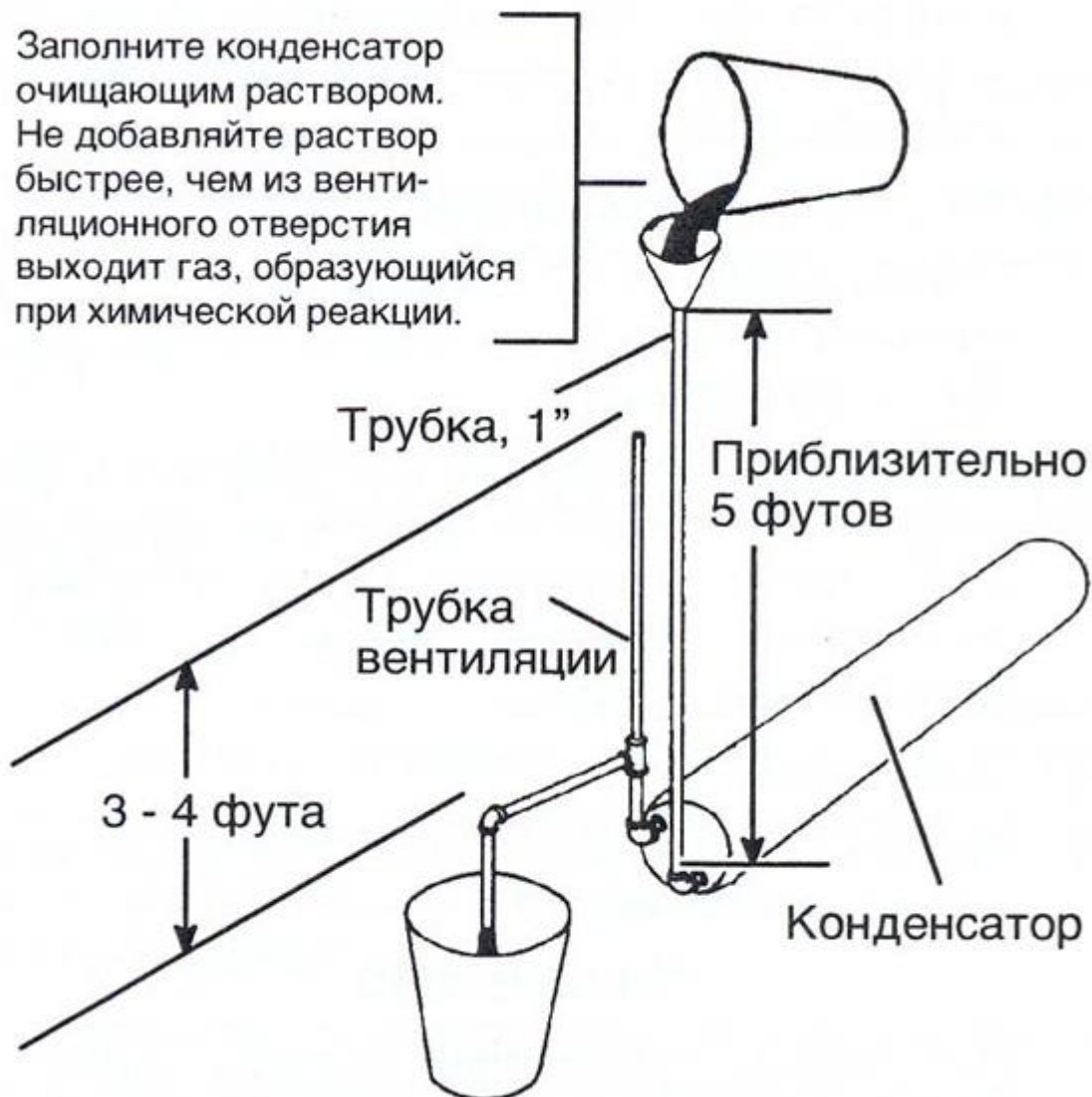
Рисунок 6-36. Очистка конденсатора водяного охлаждения - циркуляция под действием силы тяжести.
